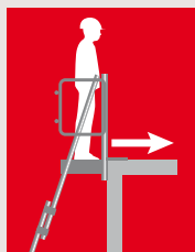
Plateforme accès dalle
